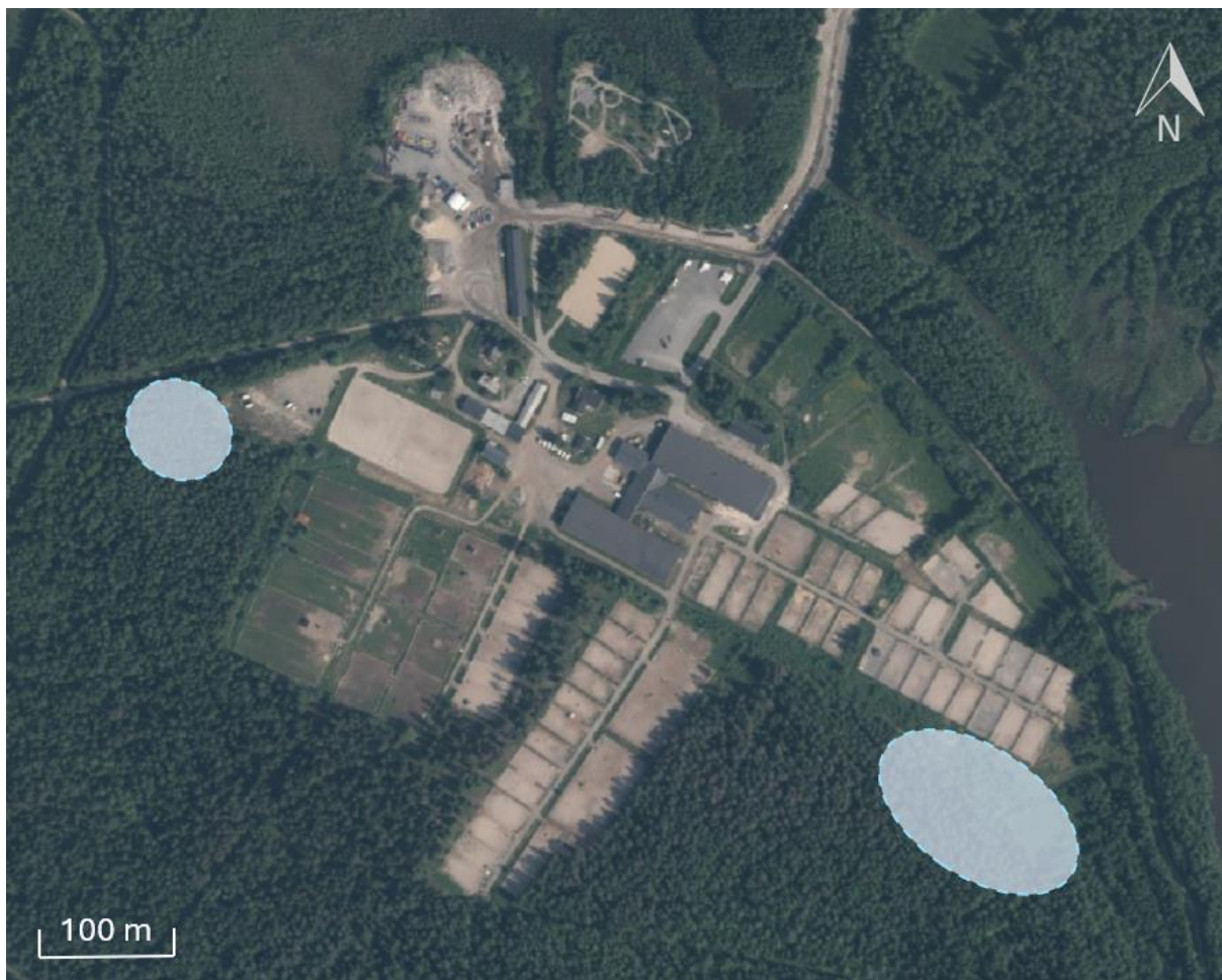
Figur 13. Översiktskarta över verksamheten med ytor som föreslås sparas till dagvattenhanteringsändamål markerade med blåa ellipser. Källa: Lantmäteriet, Min Karta (2024). Bearbetad av Vatten & Miljökonsulterna.
