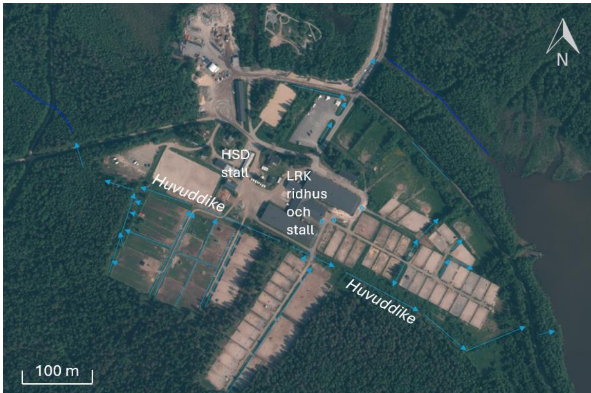
Figur 9. Översiktskarta över avrinningens flödesriktningar inom området för Hertsö ridanläggning. Uppskattade flödesriktningar är markerade med blåa pilar. Blå ringar i anslutning till LRK:s ridhus och stall representerar dagvattenbrunnar. Mörkblå liner representerar vattendrag/diken som området avvattnar till.
