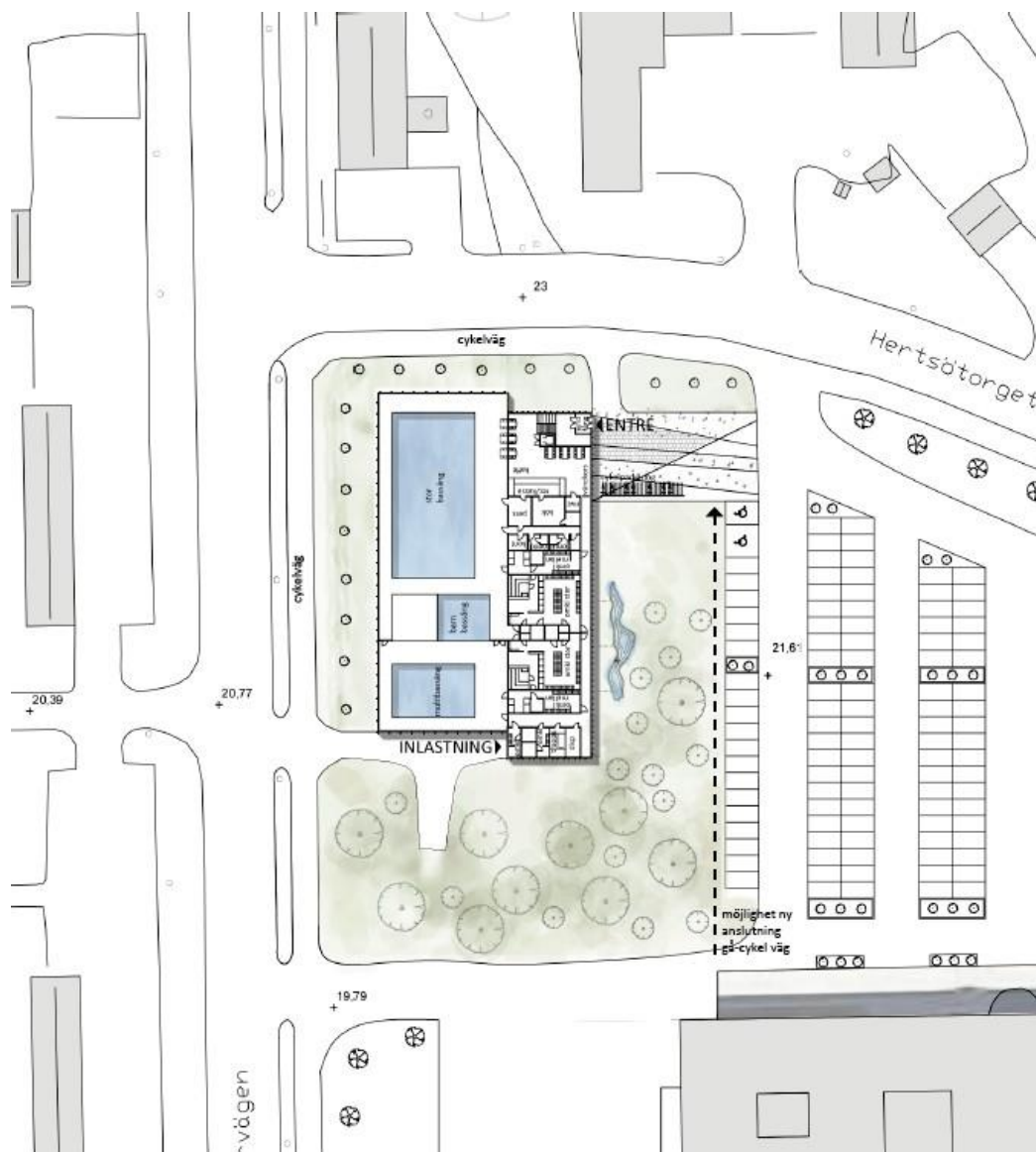
Bild 8: Bilden visar en möjlig placering och utformning av badhuset. Ytan som byggnaden upptar på marken, BYA, är enligt detta principförslag ca 1500 m 2 då byggnaden har anpassats till marknivån och utformad som suterräng. (a och d arkitektkontor)
